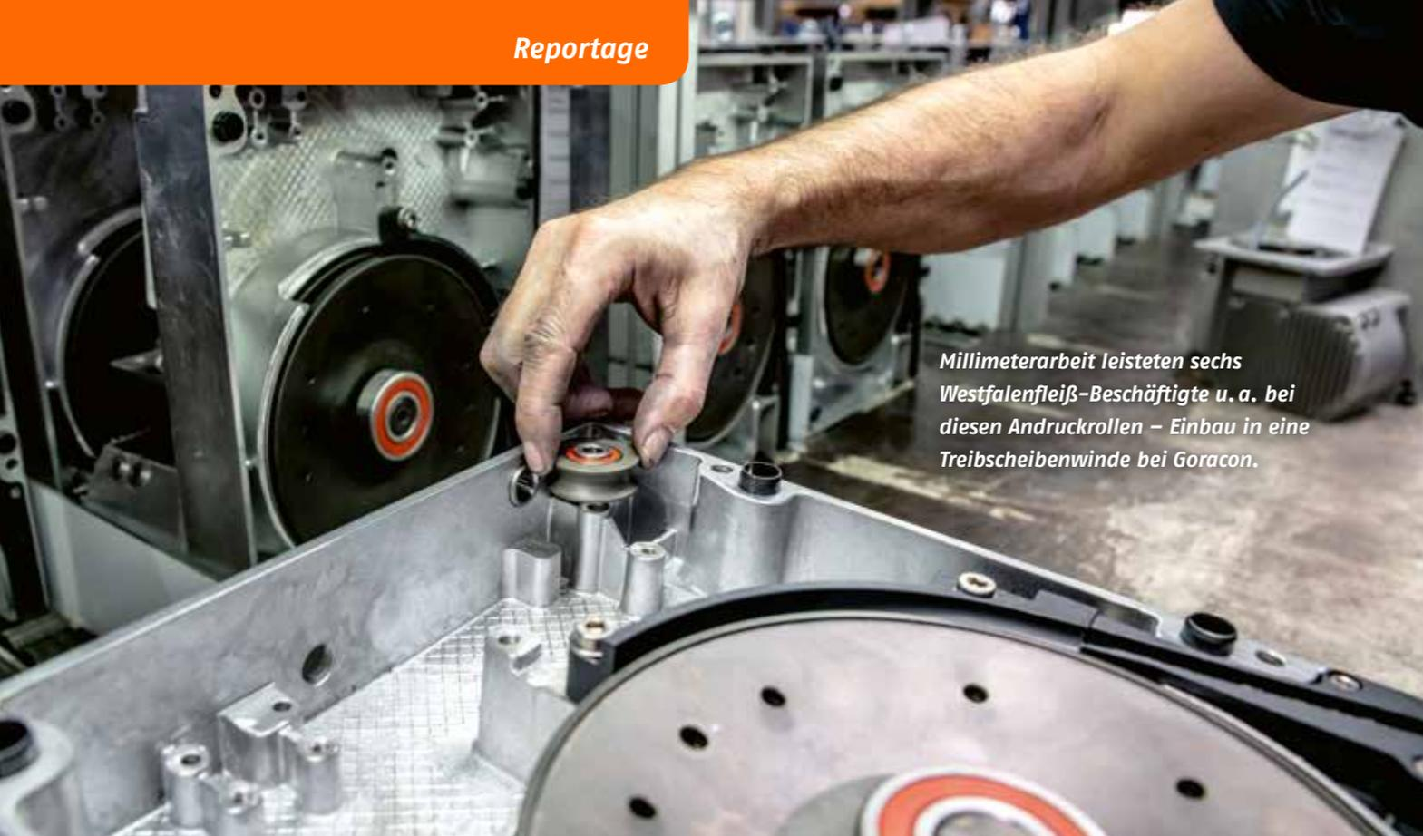
Millimeterarbeit leisteten sechs Westfalenfleiß-Beschäftigte u. a. bei diesen Andruckrollen – Einbau in eine Treibscheibenwinde bei Goracon.
